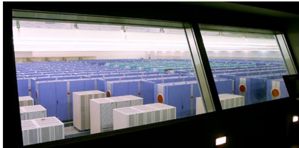
図 1: 地球シミュレータの外観。青い筐体は演算ノード、緑の筐体は通信ネットワーク。画像提供：独立行政法人海洋研究開発機構地球シミュレータセンター。
