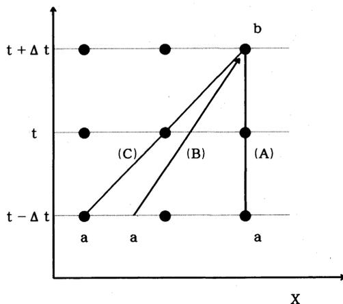
第1図 (A)は、オイラー法の積分路、(B)はセミラグランジュ法、(C)もセミラグランジュ法だが、内挿が不要。
