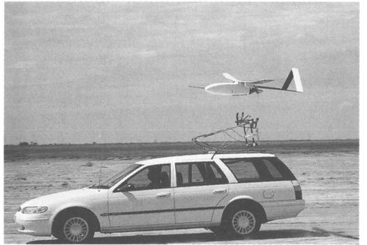
写真3 車の屋根からのエアロゾンデ離陸の瞬間。約時速80 km で十分な揚力を得られるようになると自動的に飛び出す(ポートヘッドランドの実験にて)。
