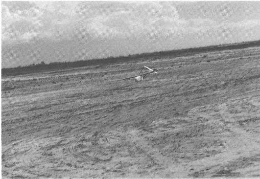
写真4 胴体着陸寸前のエアロゾンデ。高度300 m以下はラジコンと同じ誘導装置を用い、目視飛行である（ポートヘッドランドの実験にて）。
