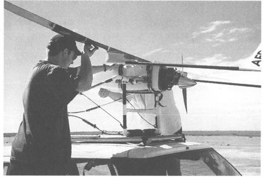
写真2 車の屋根に備え付けられた発射装置にエアロゾンデを取りつける。この後、ジャイロ、翼、通信装置などの最終点検を行い、離陸を待つ(ポートヘッドランドの実験にて)。
