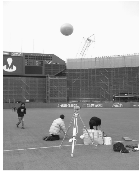
第2図 係留気球による球場内の卓越風向観測。グラウンド中央からバックスクリーン側を望む。
