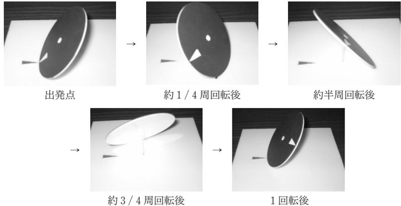
第2図 オイラーの円板の模型が、反時計まわりに回転する様子。円板につけた三角の印は、時計まわりに回転する。1回転後に、元の位置に戻らない点に注意。
