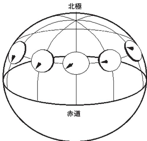
第4図 オイラーの円板の位置を、第3図の対応関係に従って、球面上に表示したものの中心位置は、緯度  $\phi$  にある。
