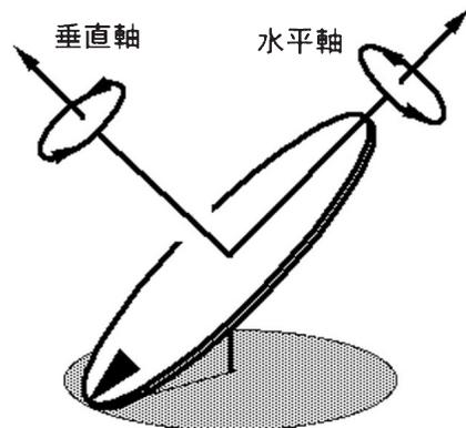
第1図 オイラーの円板の模型。円板は、床から垂直に伸びた柱によって中心が支えられている (実際の玩具には、柱はない)。水平軸の周りに回転させることによって、円板は斜めの姿勢を保って回転する。
