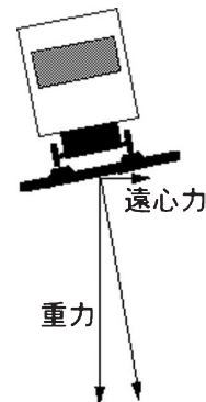
第2図 線路の傾き。重力と遠心力の合力が線路の面に垂直になるように、線路を傾ける。
