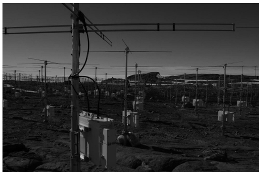
第2図 アンテナと送受信モジュール。アンテナ輻射器と送受信モジュールはRF信号ケーブルで接続されている。
