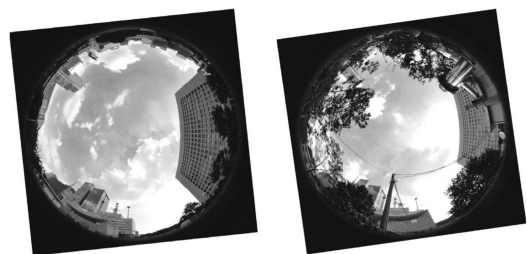
第2図 大手町露場内で撮影された天空写真。左は気象庁温湿度計（JMA）付近のもので、右は露場東端の温湿度計（Field）付近のもの。方角は上が北、右が西になる。魚眼レンズは等立体角射影方式のものである（2012年9月7日撮影）。
