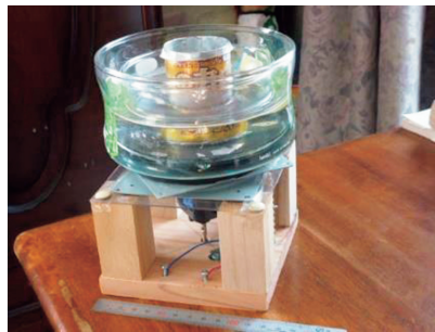
第5図 (左) ロクロを使った回転装置、(右) 携帯用の回転水槽装置。装置の大きさは、第1図の a=21 mm, b=49 mm, H=69 mm, 2R=130 mm。
