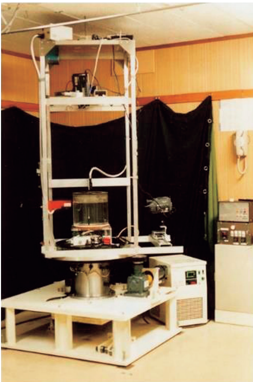
第4図 富山工業高等専門学校で開発した回転二重円盤実験台。装置の大きさは、第1図の a=41 mm, b=86 mm, H=248 mm, 2R=249 mm。黒い円盤は、実験水槽を回す円盤、やぐらが載った大きい円盤は、観測機器を回す円盤。
