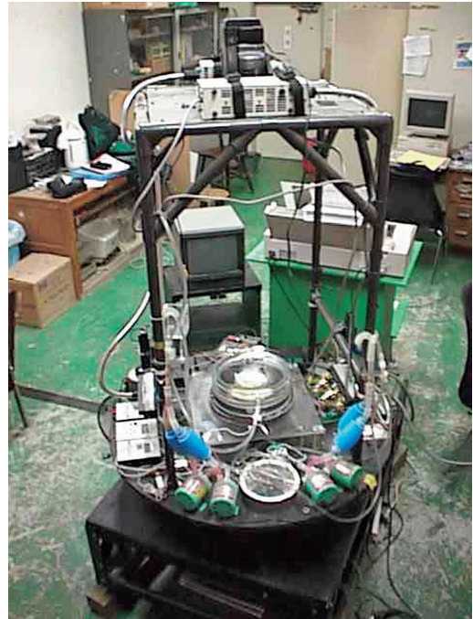
第3図 埼玉工業大学で製作した回転水槽実験装置。装置の大きさは、第1図の a=100 mm, b=240 mm, H=90 mm。水槽全体は1辺420 mm, 高さ180 mmの正方形の容器に入っている。
