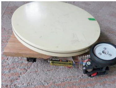
第5図 (左) ロクロを使った回転装置、(右) 携帯用の回転水槽装置。装置の大きさは、第1図の a=21 mm, b=49 mm, H=69 mm, 2R=130 mm。
