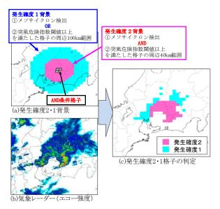
第10回 発生確度2・1の解析方法 発生確度2・1背景は、その場所で1時間有効. 降水ナウキャストの移動速度でエコー強度を移動 させ、発生確度2・1背景と強いエコー強度が重な る格子を発生確度2や1として解析する.
