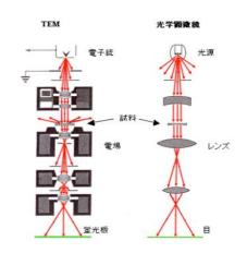
図6. 電子顕微鏡と光学顕微鏡の比較
