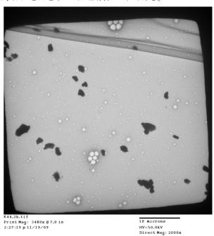
図8.2009年3月に福岡大学で採取された黄砂粒子
