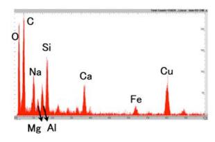
図9. 鉱物ダストのEDX分析結果の例。横軸はX線の波長、縦軸はカウント数
