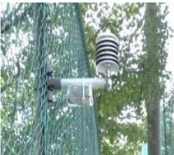
各班員の出身中学校に自作の観測機材図1を取り付け、五分間隔で気温・相対湿度・気圧を観測した。本研究では立正大学重田先生所有のデータも使用させていただいた。
