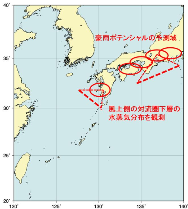
図 3.6.5. 大雨を対象とした日本南岸における水蒸気量の航空機観測計画。大雨が発生しそうな場合に、暖湿気塊の流入域における温度、水蒸気量、風向・風速の観測をレベルフライトで行う。モデルとの水蒸気量のずれを観測するとともに、水蒸気量の水平変動量を調べ、格子内水蒸気量の分散や確率密度分布の形状を検討する。
