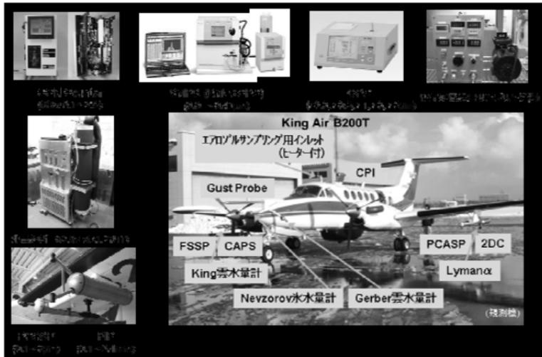
図3. 雲微物理測定器を搭載したDASのKing Air 航空機
