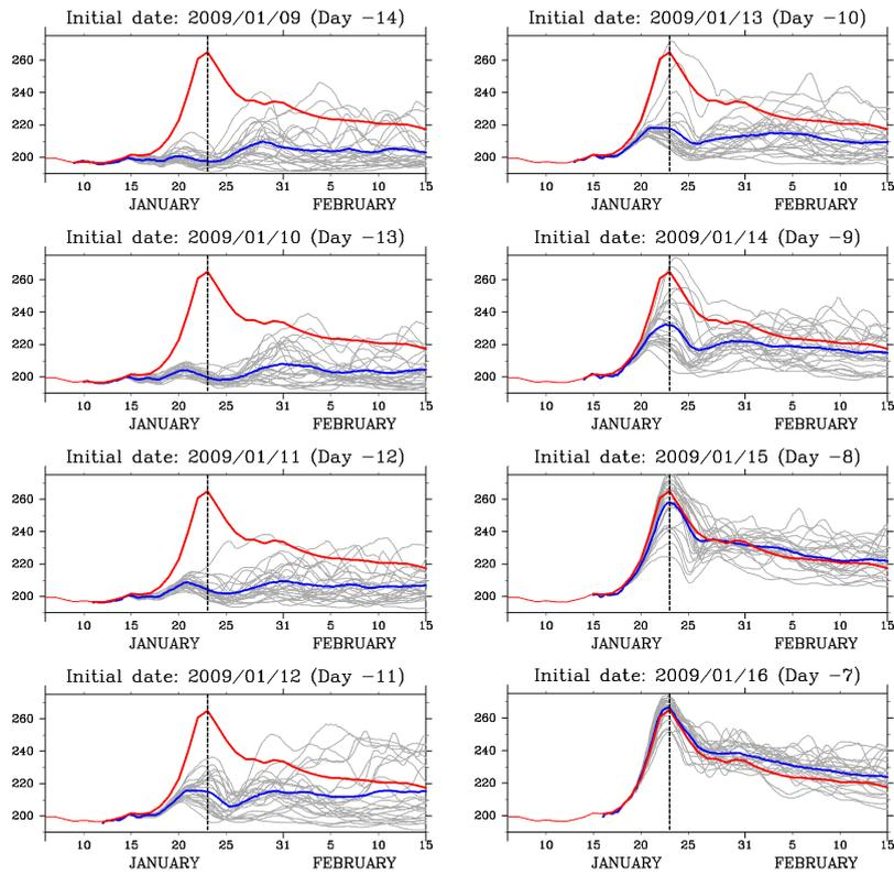
Fig. 3 2009年1月のSSW発生期におけるアンサンブル予報結果。80°N以北で平均した10hPa温度の時間変化を示す。赤色は観測値、青色はアンサンブル平均予報値、灰色は各アンサンブルメンバーの予報値
