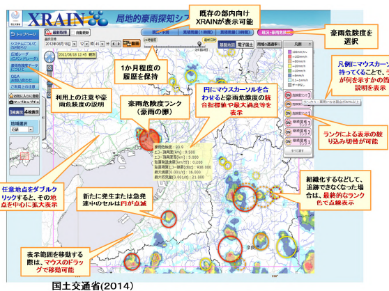
図6 国土交通省により試験運用されている局地的豪雨探知システム(ゲリラ豪雨の早期探知と鉛直渦度による危険性予測システム) 3), 9)
