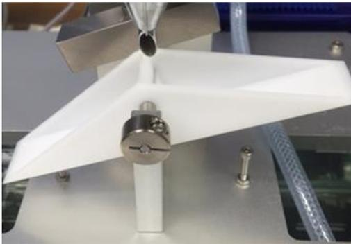
図1 新規転倒ます型雨量計の外観図
