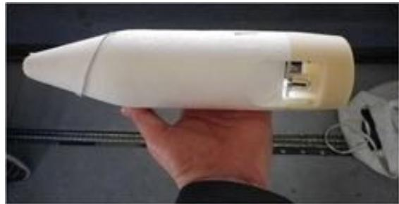
図6 明星電気株式会社により開発されたドロップゾンデの外観。
