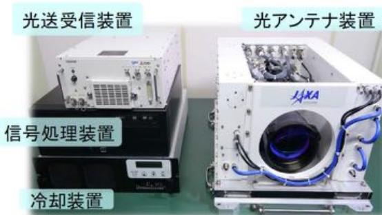
図8. JAXAが開発したドップラーライダー
