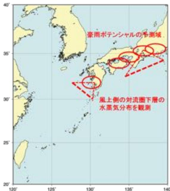
図2 大雨を対象とした日本南岸における水蒸気量の航空機観測計画。大雨が発生しそうな場合に、暖湿気塊の流入域における温度、水蒸気量、風向・風速の観測をレベルフライトで行う。モデルとの水蒸気量のずれを観測するとともに、水蒸気量の水平変動量を調べ、格子内水蒸気量の分散や確率密度分布の形状を検討する。
