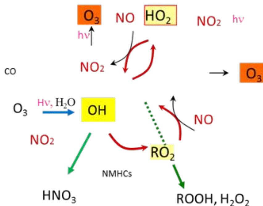
図 1. OH,  $HO_2$  ラジカルを中心とする対流圏光化学理論と、その連鎖反応によるオゾン生成メカニズム。これらの反応系には描かれていない未知過程が潜んでおり、あらゆる大気物理化学環境中の検証が求められている。
