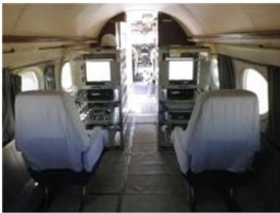
図5 G-II機内に設置された2台のドロップゾンデ受信機。
