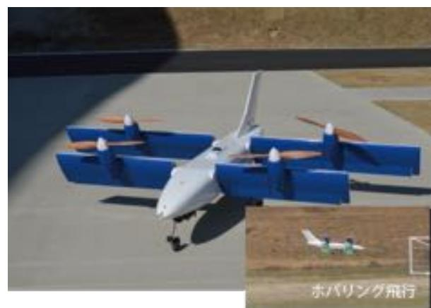
図3. QTW: 4発ティルトウイングVTOL小型無人機 (静岡県実用実証機体、25kg)
