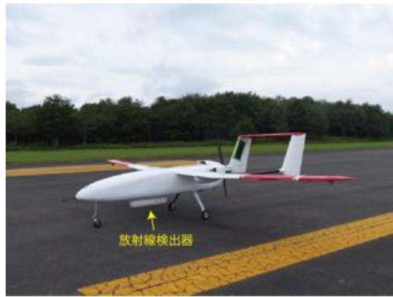
図1. UARMS(放射線モニタリング) 小型固定翼無人機
