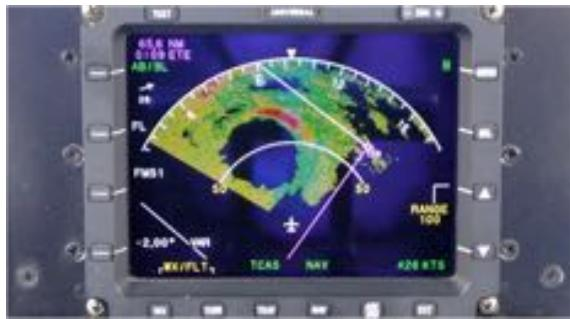
図7 台風の周辺飛行時のG-IIの機種レーダによる反射強度分布。緑色、黄色、赤色、紫色の順で反射強度が強いことを示し、赤色や紫色の領域の飛行は危険であるとされている。水平面から-4度のルックダウン画像である。白い弧状の線は手前側（飛行機の絵が描かれている）から50マイル、100マイルの距離を示す。飛行機の進行方向左側の円形の反射強度のない領域が台風の眼である。
