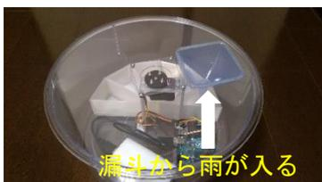
また、水センサを使い、雨の降りだしを検知し、降り始め丁度から採取できる。（下の写真は蓋を取った場合）
