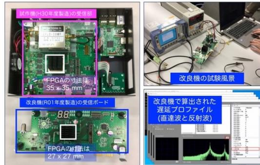
図 2 試作機と改良機の受信ボード部と改良機で取得された遅延プロファイルの例
