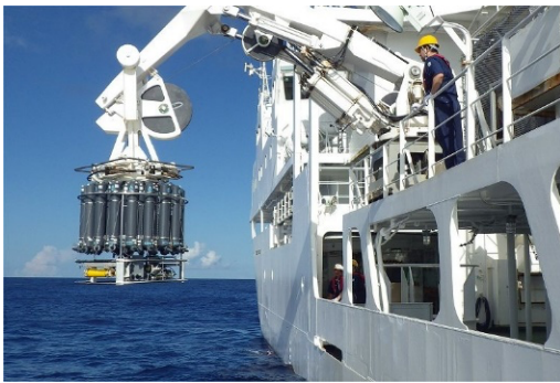
写真 1 気象庁の海洋気象観測船における CTD システム
