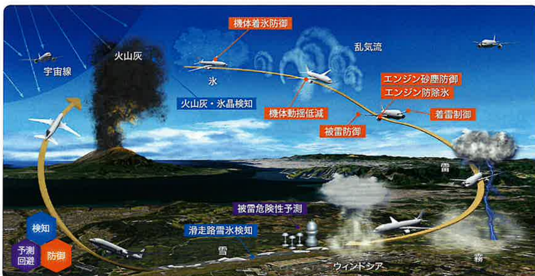
特殊気象 (雪氷・雷・火山灰・乱気流等) から航空機を守るため、機体・滑走路の状態や気象状況を検知し、予測・防御する気象影響防御技術
