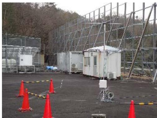
図 1. 信楽 MU 観測所に設置された受信専用ターンスタイルアンテナ。
