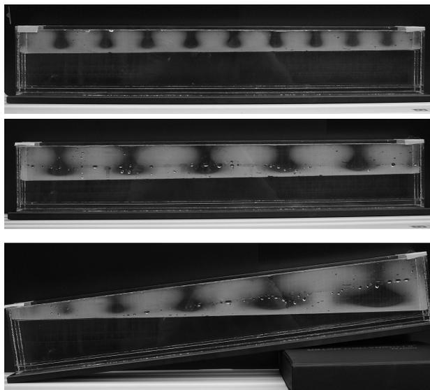
図 2 規則的な対流パターン．空気層の厚さに比例してセルのサイズが変化する．
