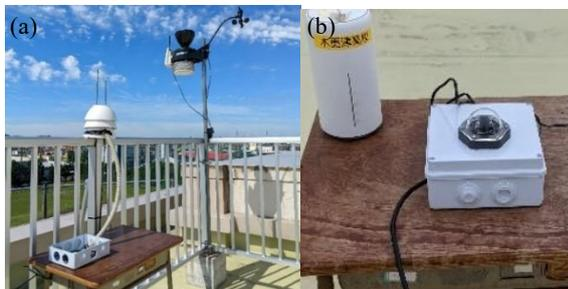
図 1 ラズパイ観測器とウェザーステーション (a) とラズパイカメラ (b)
