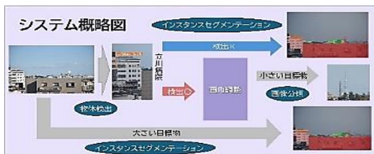
図1 視程の自動観測システムの完成図
