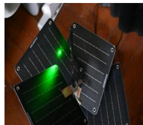
図4 太陽光パネルにレーザー光を当てた様子
