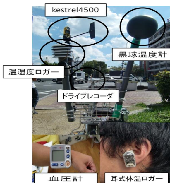
第1図 観測測器の外観図。 (上) 気象要素 (下) 生理要素の計測機器。
