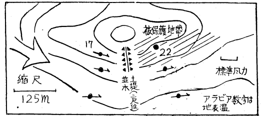
第8図 風向転換法により防風された実例1
