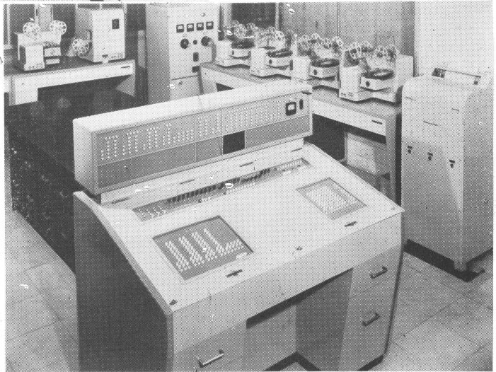
写真 2 継電器式自動計算機FACOM-128の操作室（手前が操作室で、右側向う台上には命令テープ読取機が、奥の台上左側に数値テープ）読取機などがみられる（解説を参照）
