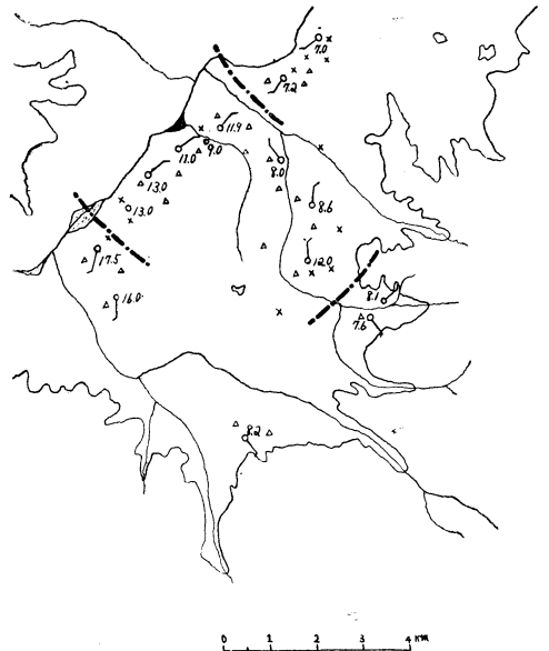
第5図 結氷量(厚mm)と気流の図(1954年11月16日早朝, 単位mm × 印霜害地点(桑の芽) △印無霜害地点 鎖線: 不連続線?)
