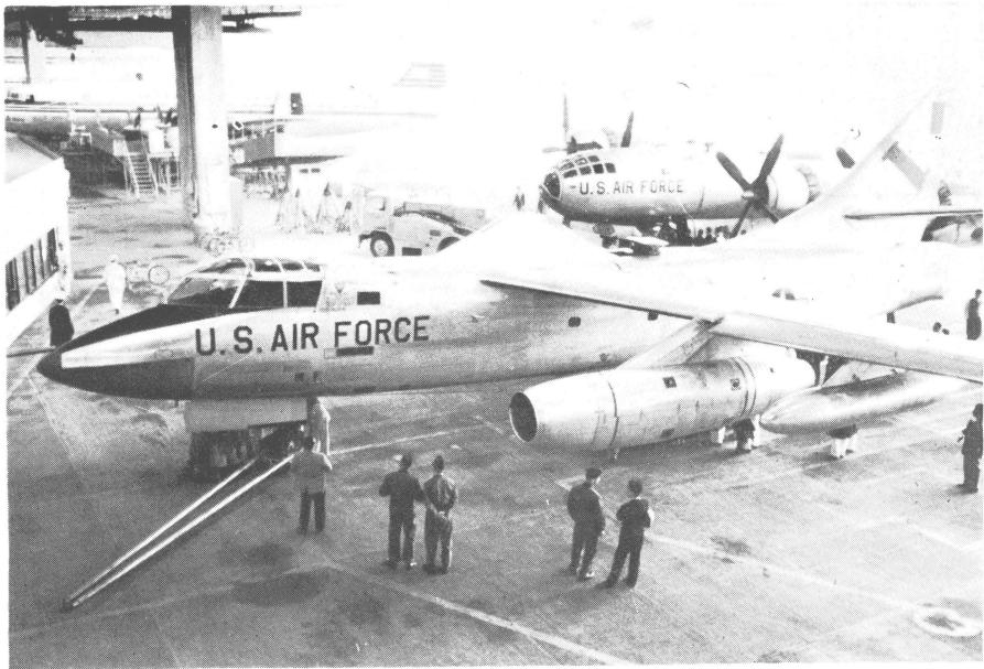
双発ジェット機であって乗員数5名、うち操縦関係の3名がフロント・グラスの部分に、無電士と気象観測員が翼の付け根あたりに見える四角形の脱出口の部分に乗る。頭部最先端に突出している棒状のものは速度計、頭部下部の黒色の部分にレーダー・アンテナが入っている。胴体の文字“FORCE”的FOの下に空気取入口、翼の付根の下にカメラ・アイがある。
