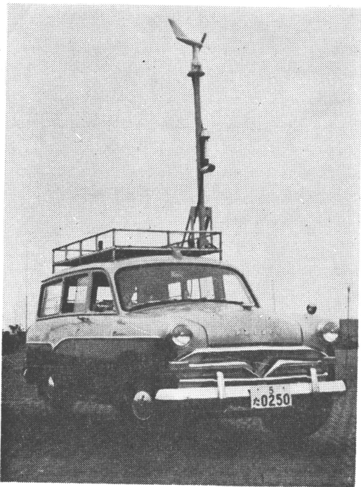
プリンスライトバンを改装した東京航空地方気象台の観測車、屋根にエネロペーンをつけて、内部には観測室及び指令塔と連絡できる超短波施設を2機もっている。
