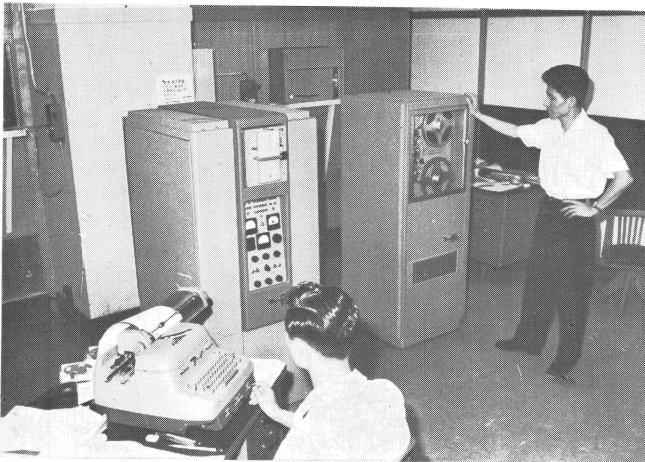
口絵 No. 5. ジェット機の経済運航のためには、ジェット機を最高高度に利用する最短時間飛行航路を決めて運航する必要がある。日本航空では航空気象台の 200mb 天気図を基に写真に示すベンディックスの G-150 型電子計算機を用いて最短時間飛行航路を決定する。
