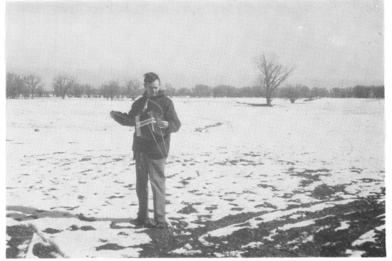
イギリスの Brewer 型オゾンゾンデの飛揚直前の調整
