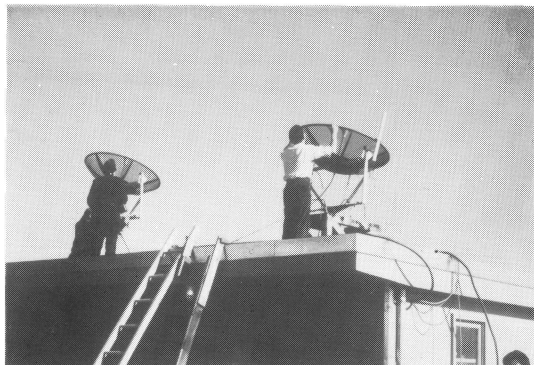
1680メガ受信機アンテナ，連結した2種のオゾンゾンデは共に1680メガ帯(10 M.C.程度の差)のため，2台使用，手でゾンデを追跡する。
