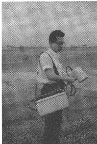
第2図 Barnes社 PRT-5型赤外線放射温度計(アスファルト道路の温度測定中)
