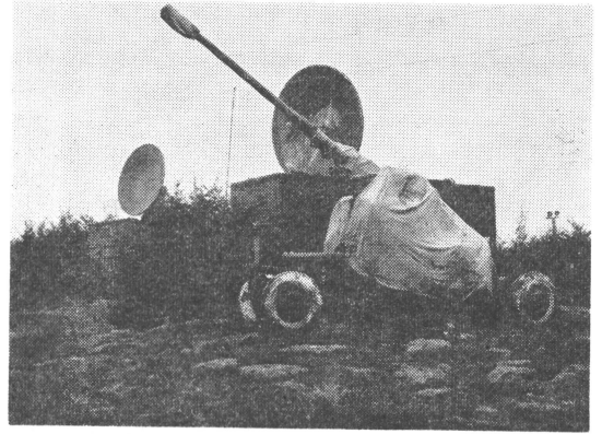
第2図 雷雲探知用レーダー；左3cm波、右10cm波アンテナ、手前の砲は予備用。
