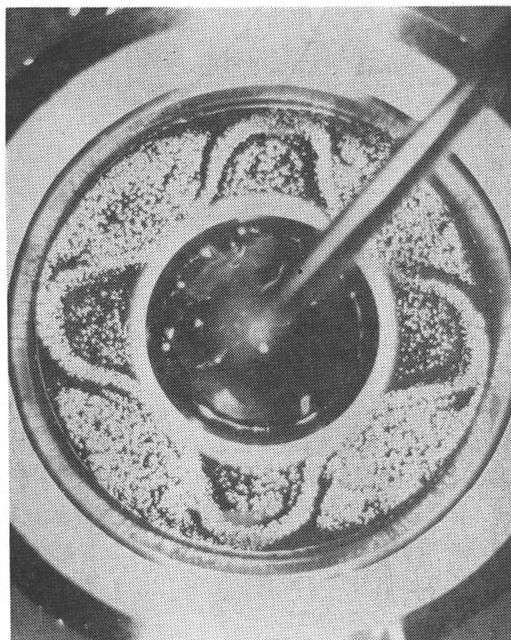
第3図 波動（渦運動）の例。波数  $n=4$ ,  $\Delta T=10^\circ$ ,  $d=10$  cm,  $\Omega=1.0/\text{sec}$
