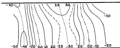
第12図 波動に伴う圧力分布(平均からのずれ)。数字は c.g.s 単位をもっている正負の値は、それぞれ平均より高圧、低圧を示す。波の進行方向は、右向きである。データは図11と同じ。
