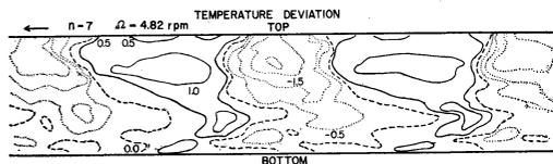
第11図 波動に伴う温度分布。但し平均からのずれだけが示されている(数字はそのずれの温度(°C))。実線は平均より暖い部分、点線は冷い部分を示す。測定点の位置は、内外壁間の中央部。左上方の矢印は波の進行方向。 $n=7$ 。データは図10と同じ。但し、 $\Theta=1.0$ 、 $T_a=8 \times 10^7$ 。
