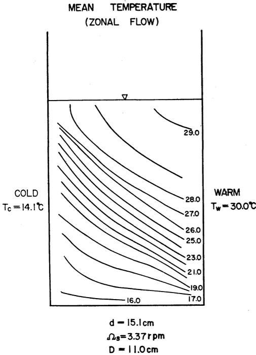
第10図 軸対称流内の温度分布。実線は等温線であり、そばの数字は温度(°C)を示す。ΔT = 16°C, d = 15.1 cm, Ω = 0.34/sec. 対流槽の幅 D = 11.0 cm, Ω = 2.4, Ta = 4 × 17°.
