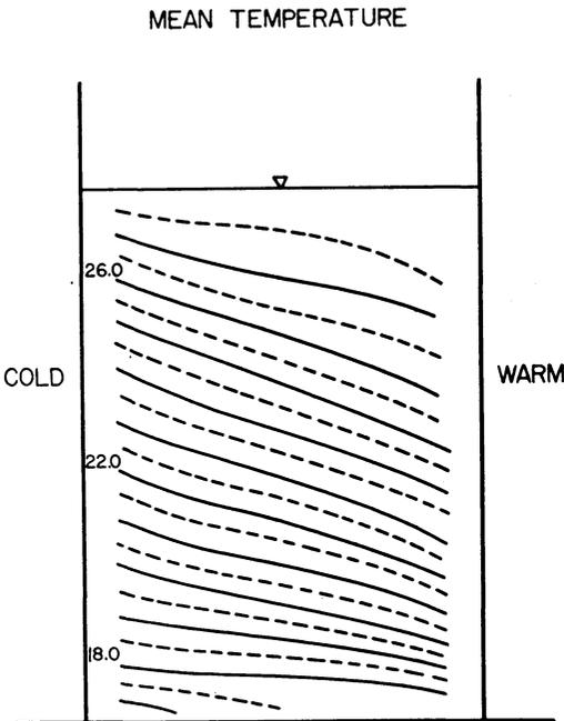
第14図 波動領域の平均子午面内の温度分布。実線、点線共に等温線。数字は温度(°C)を示す。データは第11図と同じ。
