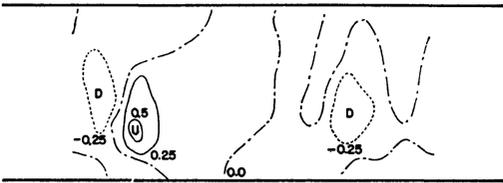
第13図 波動に伴う上昇・下降流。Uが上昇、Dが下降である。数字はc.g.s単位をもっている。波の進行方向は右向き。データは第11図と同じ。
