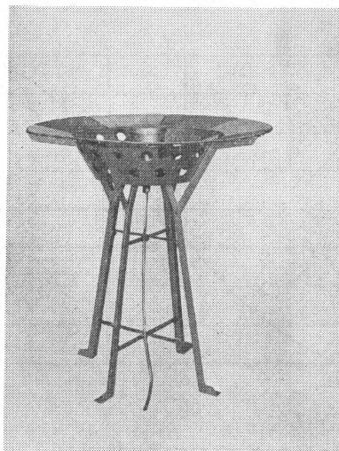
第6図 無線ロボット雨量計の風除け
