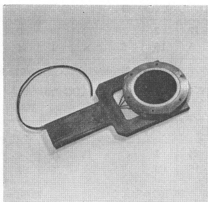
第16図 熱電対を素子とした放射収支感部
