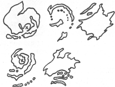
第20図 レーダーエコーからみた台風の分類，有眼台風：左上一層状型，左下一線状型，無眼台風：中上一拡散型，中下一変質型，右上一无形成型
