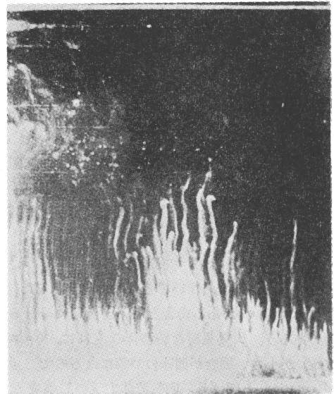
第7図 salt finger の流体実験 (Turner, 1973). 高温の食塩水 (黒色) と低温の真水 (無色) を重ね合せると、境界層に鉛直流が生じる。
