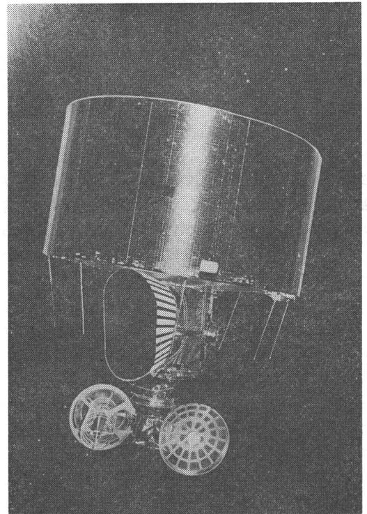
S-band と UHF の空中線は機械的デスパン方式で、空中線と本体の間に VISSR の開口部が見える。
