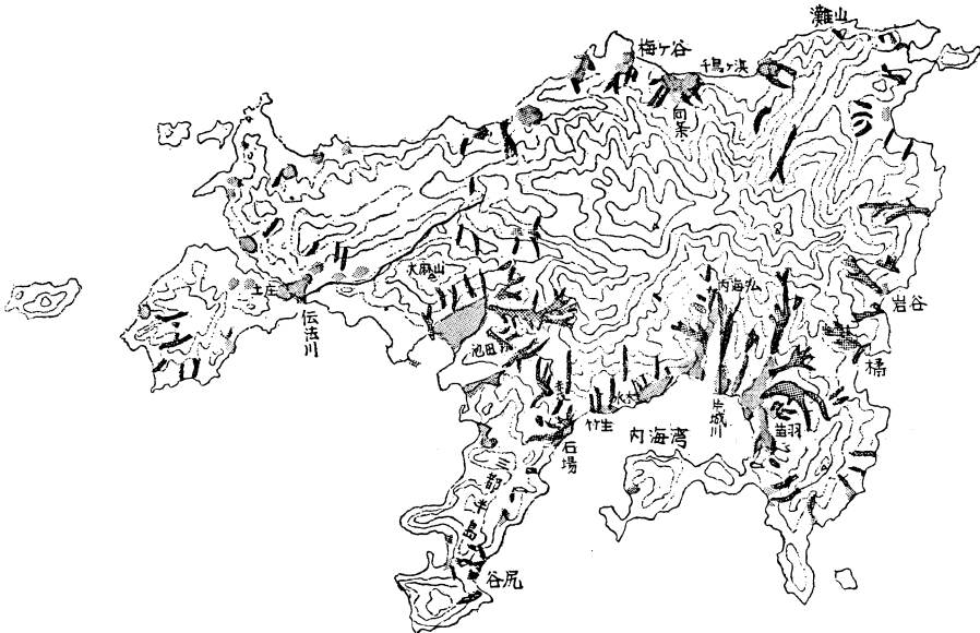
第6図 51.9 豪雨による小豆島災害図 (航空写真をスケッチしたもの)。濃い点域は土石流を含む土砂崩壊域, 淡い点域は土石流を含む冠水域。
