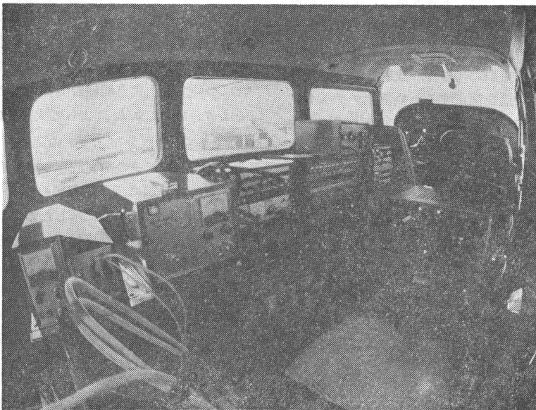
第2図 セスナ機の測器配置状況（上段：左側より、SAT 温度、鉛直風速、サーミスタ乾湿球、熱線風速計と冷線温度計、下段：インナーシャルプラットフォーム、データレコーダー）。
