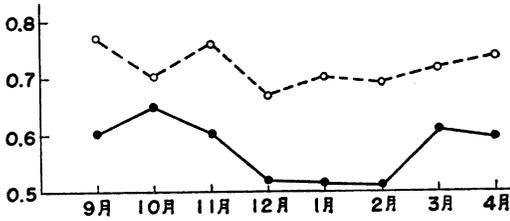
第22図 900 mb 面における24時間高度変化(実測と予報)の相関係数の月別変化. 点線は非断熱大気モデル, 実線は断熱大気モデル.
