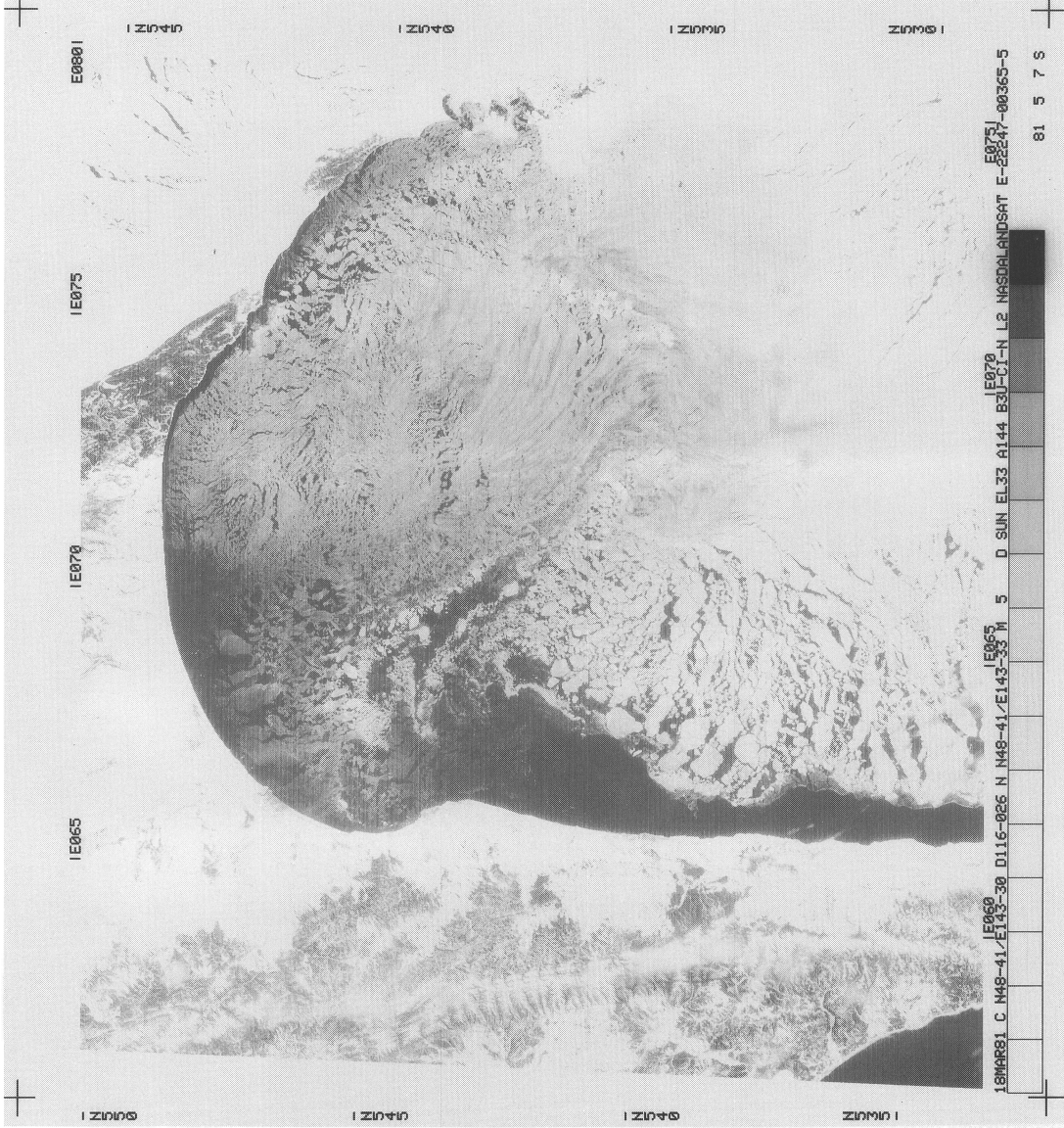
写真2 1981年3月18日0037Z ランドサット2号の画像(バンド5)。 画面中心はサハリンのタラライカ湾(48°41'N, 143°30'E)。バンド5のため、厚い氷の白色域はつぶれた調子になっている。
