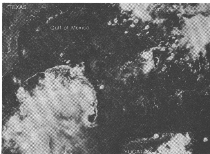
写真 1 直径約270マイル (400 km) の雷雲。雷雲からの冷気の吹き出しの先端のアーチ状雲列が雷雲から外に向かって移動していく様子を示す連続写真の1コマ。(WAB 456 より)
