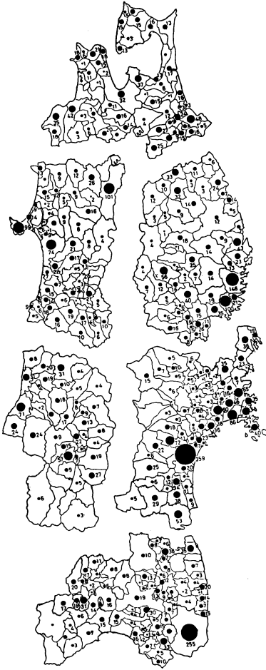
第1図 市町村別急傾斜地崩壊危険箇所数分布。資料；青森県地域防災計画資料編(1984)，秋田県地域防災計画資料編(1984)，岩手県地域防災計画資料編(1984)，宮城県地域防災計画資料編(1984)，山形県地域防災計画(1977)，福島県地域防災計画(1984)。
