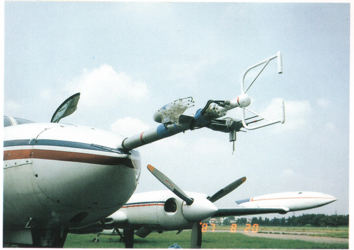
写真 1 セスナ 402 の機体にとりつけられた風向風速と温湿度の変動を測定する機器
