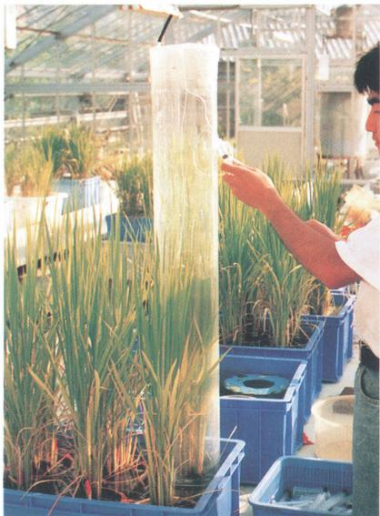
写真1 水田土壌から水稻体経由で大気中へ放出されるメタン捕集方法(本文(P731~P736)および第3図参照)。
