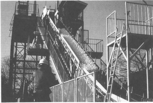
写真3 10,000個のピンポン球を用いた雪崩のモデル実験。
