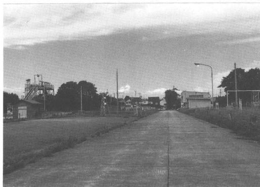
写真1 新庄雪氷防災研究支所の構内。冬は深さ1.4m(平年の最大積雪深)の雪でおおわれる。左端に雪崩実験シュートがある。
